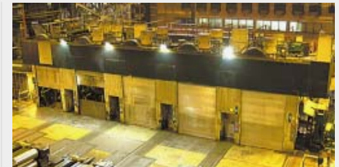
Der Betriebsversuch mit der Walzemulsion Fuchs Trefoil S 829 wurde an der Tandemstraße 2 von Arcelor Gent durchgeführt. Es wurden in dem neun Monate laufenden Test ca. 200 Gramm des Schmierstoffs pro Tonne Stahl verbraucht. Produziert wurde in diesem Zeitraum rund eine Million Tonnen Stahl.
